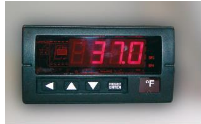
デジタルディスプレイ 出力と温度の表示 （オプション：リレー表示）
