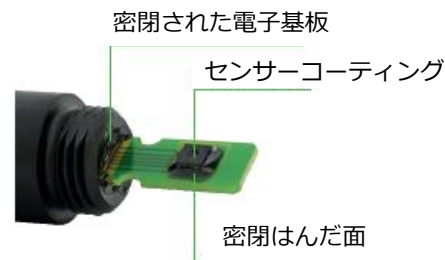
フィルタ内部のセンサーヘッド（コーティング付）
