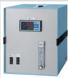
露点簡易測定ユニット TKZH004
