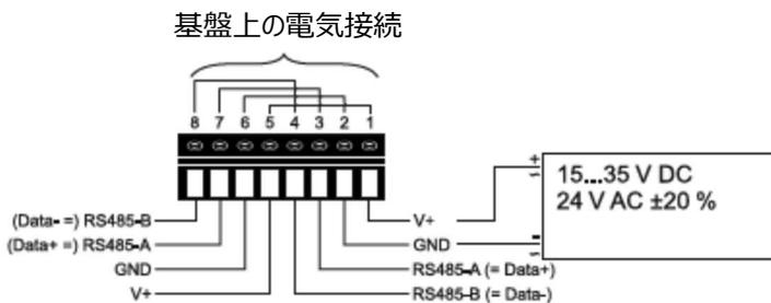
結線端子は機器直列接続(Daisy-Chain wiring)に適しています。
