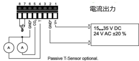
重要事項：仕様に沿った障害のない動作と性能を得るために、電源 GND と測定 GND は別々に配線することを推奨します。やむを得ず電源 GND と測定 GND を共通配線とする場合は、共通配線の電圧降下による影響を考慮する必要があります。
