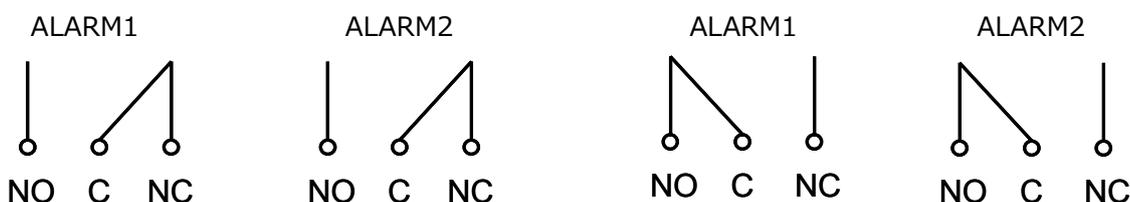
※上記の接点を変更出来ます。変更する場合は、機器とパソコンを専用ケーブルで接続し、AMI 社のソフトウェア（オプション）で変更します。
